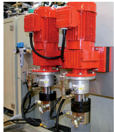
Zahnraddosierpumpe mit aufgebautem Volumenzähler für 2- oder Mehrkomponenten-Dosieranlagen
